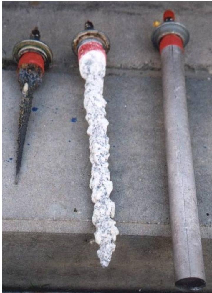
Das obige Bild zeigt, wie sich ein Opferanode in einem Trinkwasserbereiter mit der Zeit abbaut. Rechts eine ungebrauchte Opferanode, in der Mitte eine Anode, die schon einige Zeit in Betrieb gewesen ist, jedoch noch ca. zu 60 % besteht. Links eine Anode, die ihren Dienst erfüllt hat und vollständig aufgelöst ist.
